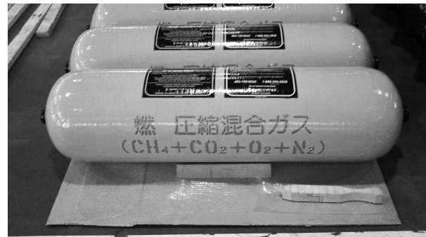
写真 1 バイオガス輸送用高圧ガス容器
