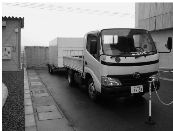
写真4 バイオガストレーラーと牽引のためのトラック Photo 4 Bio-gas trailer and tractor truck
