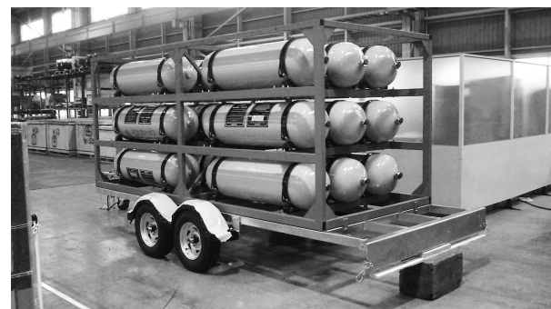
写真 2 バイオガス輸送用トレーラー（容器搭載中）
